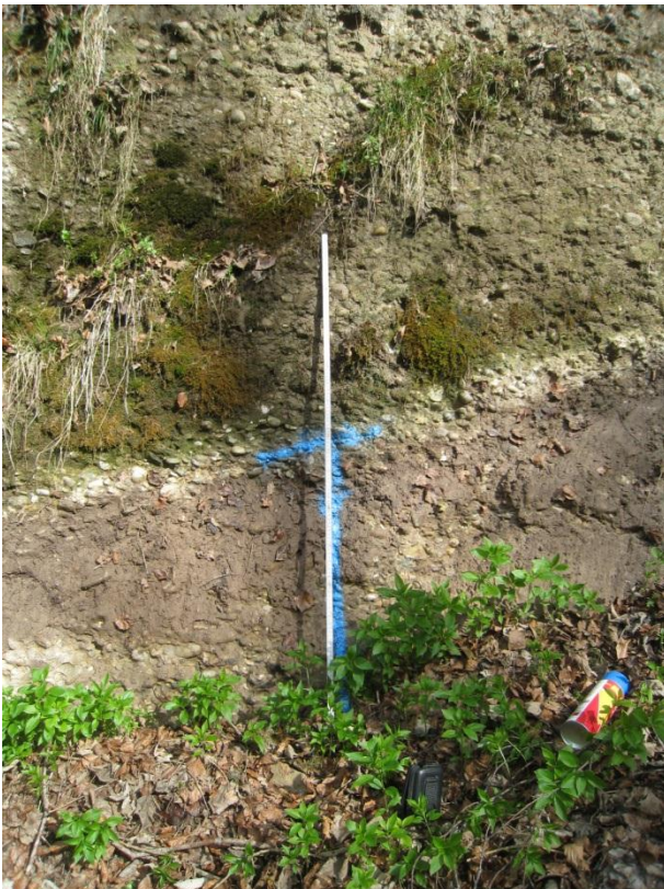
Absenkung der Rutschmasse im Anrissbereich; an dieser Stelle um ca. 60 cm. Die Geschwindigkeit der Absenkung liegt im cm-dm Bereich.
