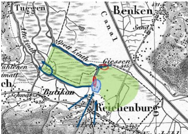
Ermittlung der Grundwasserverhältnisse und der Fließtendenzen.
