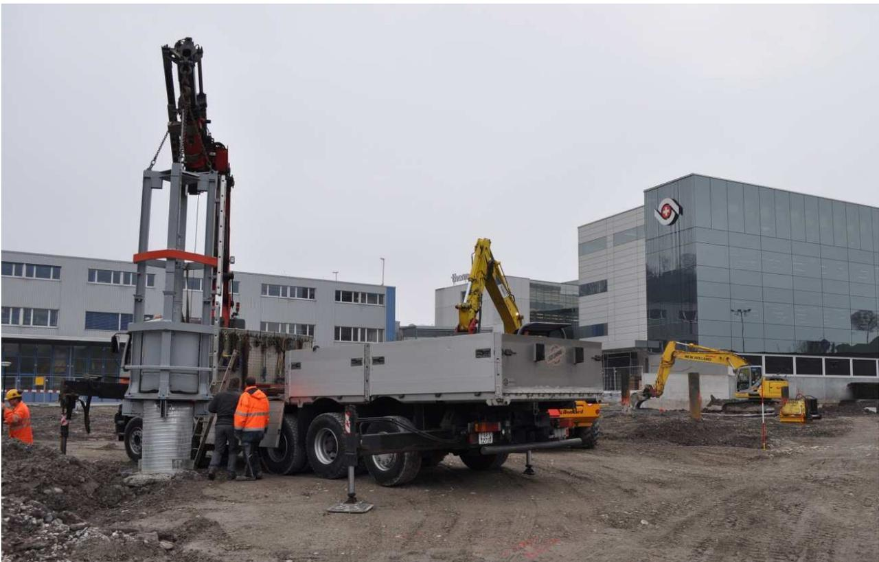
*Mit dynamischen Pfahlversuchen wurden das Tragfähigkeitsverhalten und die Qualität der erstellten Pfähle verifiziert. Durchführung durch Fa. DUBA Pile Control AG, Januar 2013.*
